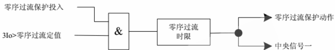
图 3-4 零序过流保护逻辑图
